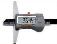
Paquímetro digital de profundidade
