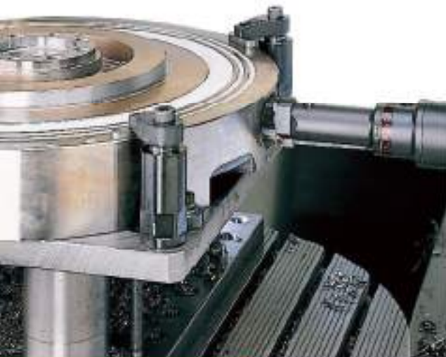
Fig. 3 – Os cabeçotes de mandrilhamento são ajustados com a possibilidade de utilizar somente uma cápsula, para operações de desbaste e acabamento com remoção leve de material. A placa de proteção para o serrilhado deve sempre ser usada para este tipo de operação.
